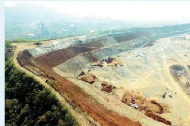
矿区施工台阶式开采，边开采、边治理边坡绿化
